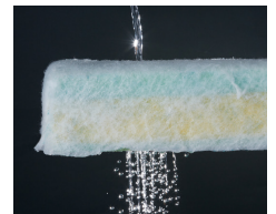
ムマックはウレタンフォームの気泡にあるフィルム状の膜を取り除き、空気や水を通り易くした無膜ウレタンフォームです。
