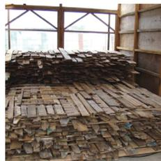
太陽光を利用した炉の中でしっかりと乾燥させてから再利用します。
