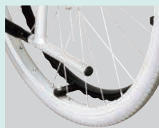
段差などで介助者が、前輪を上げる時に足をかけて踏み込むためのレバー。
