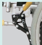
車イスを停止又は、制動するためのブレーキ。
